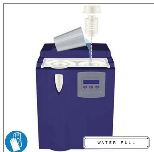
Llene el depósito de agua con agua dulce desionizada a un nivel de aproximadamente 15 mm por debajo del borde superior del cuello del depósito. Al encender el generador se producirá una indicación visual y sonora cuando se alcance el nivel correcto.
