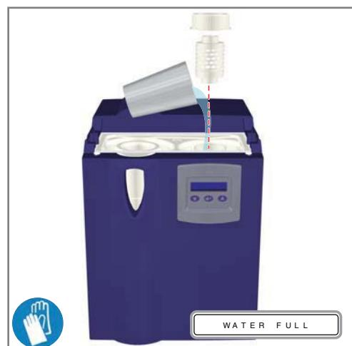
Riempire il recipiente dell'acqua con acqua fresca deionizzata fino a un livello di circa 15 mm al di sotto del bordo superiore del collo del recipiente. Se il generatore è acceso, emetterà un segnale acustico e visivo quando viene raggiunto il livello corretto.
